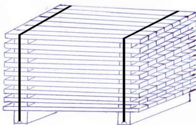
**25x95x1130** -- количество досок в одной пачке-402шт.Укладка производится следующим образом- вверх складываются двадцать пять рядов по двенадцать досок в ширину, между каждыми рядами идут прокладки по четыре штуки из этого же материала. Плотны стянуты двумя кольцами ленты по краям. Круги ленты, прокладки, ножки строго друг под другом. **Ножки идут в учет 2-ве ноги по 3-ри шт.!**
